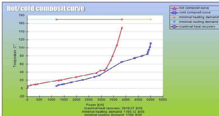
Figura 23: Curva compuesta de calor y frío para una empresa lechera con líneas de producción de leche, queso, cuajada y mantequilla
