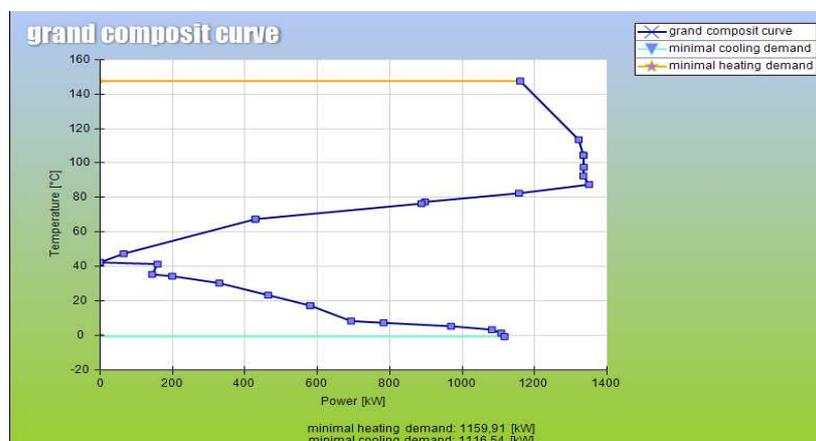
Figura 24. Grande Curva Composita di un'industria casearia produttrice di latte, formaggio, cagliata e burro
