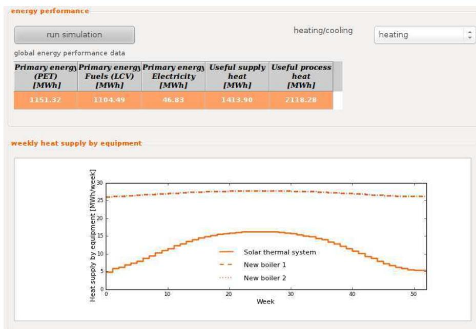
Figura 38. Fornitura di calore settimanale per tipo di impianto. Alternativa "ST-ETC-600".
